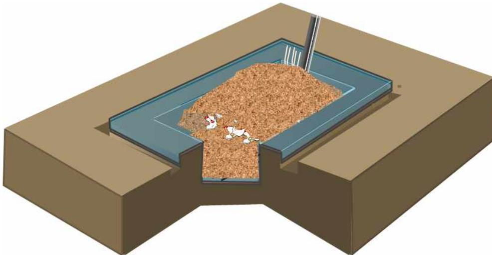
그림 13. 호기성호열미생물을 이용한 소취용 봉분층 만들기 개요도
