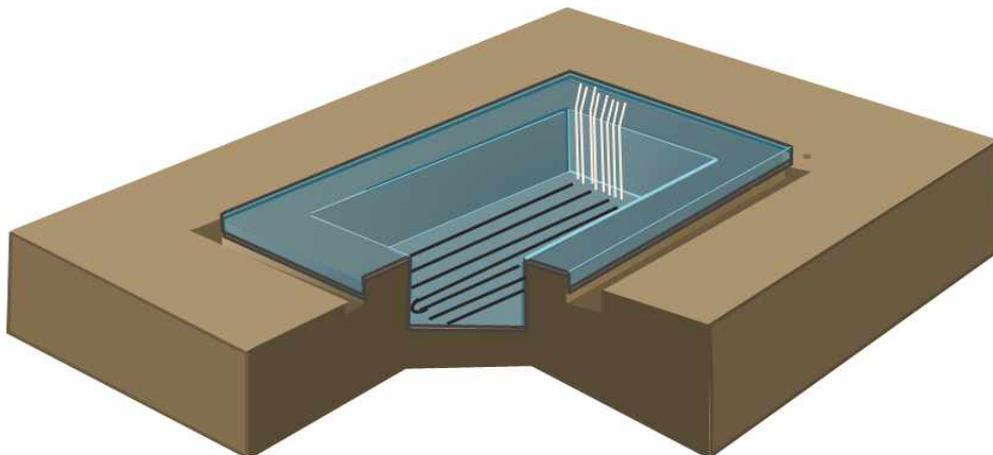
그림 10. 저압분산고무질호스(유니바이오토크스-바닥) 및 엑셀파이프(벽면) 설치개요도
