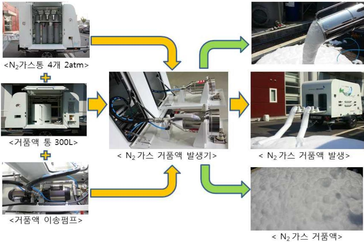
그림 1. 질소 가스거품 발생 장치 모식도
