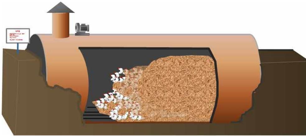
그림 15. 저장조를 이용한 호기성호열미생물 가축 매물처리 개요도
