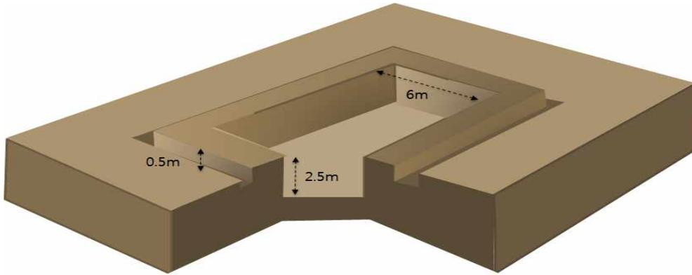
그림 4. 호기성호열미생물을 이용한 가축사체 처리를 위한 터파기 개요도
