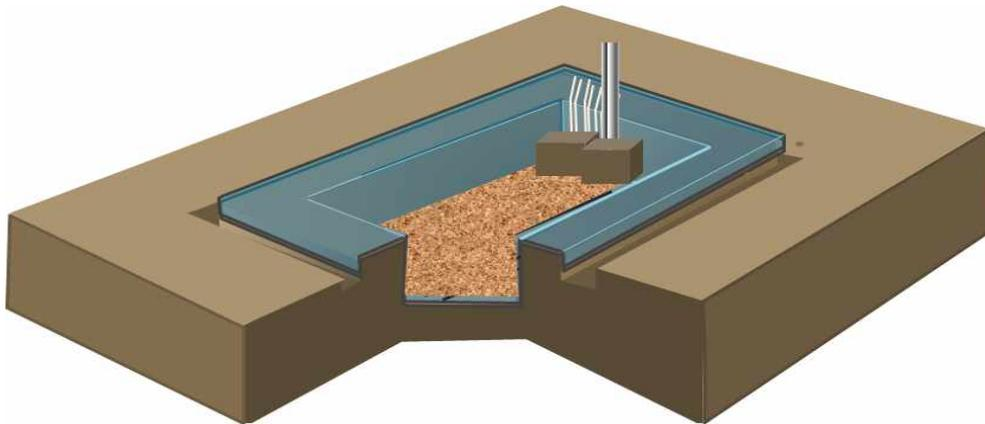
그림 11. 매몰지 내부 침출수 관찰용 유공관 설치 개요도
