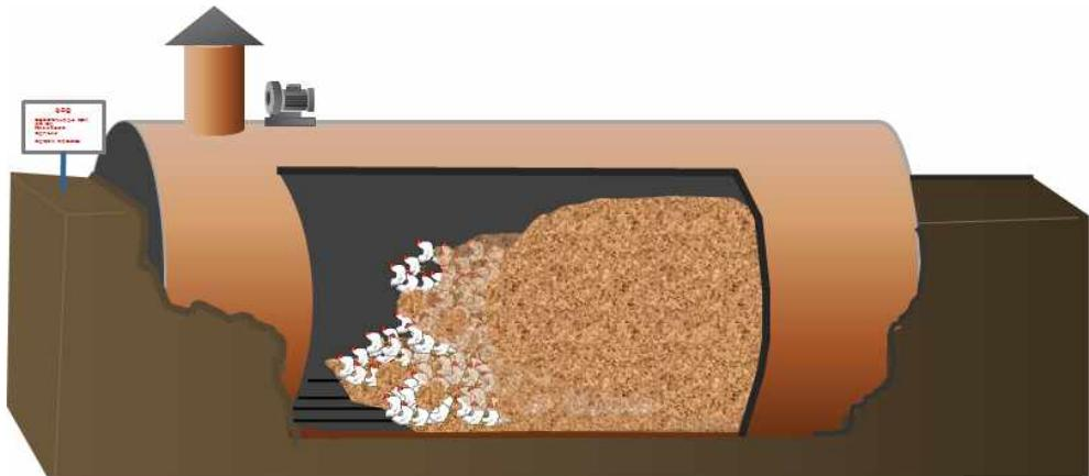
그림 15. 저장조를 이용한 호기성호열미생물 가축 매몰처리 개요도
