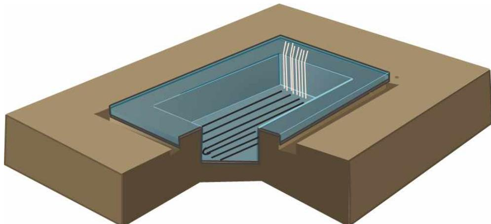
그림 10. 저압분산고무질호스(유니바이오호스-바닥) 및 엑셀파이프(벽면) 설치개요도
