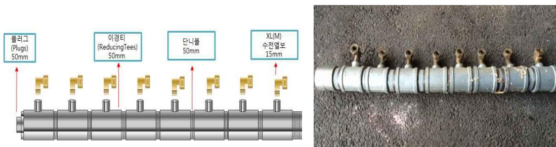
그림 9. 공기분배관 모식도 및 조립방법
