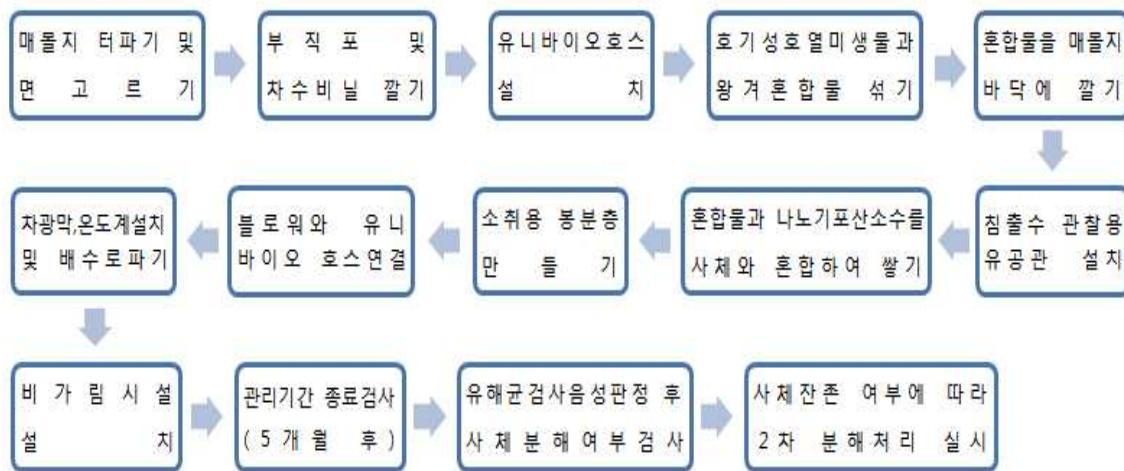
그림 1. 호기성호열미생물을 이용한 가축사체 처리 절차도
